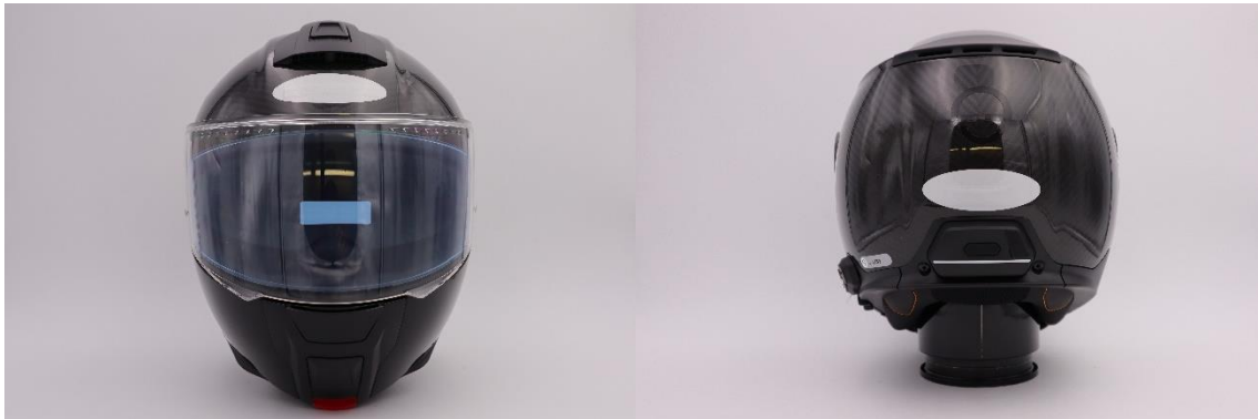
Fig. 1 Position of reflecting tapes on the helmet front and rear view Abb.1 Position der reflektierenden Tapes am Helm in Vorder- und Rückansicht
