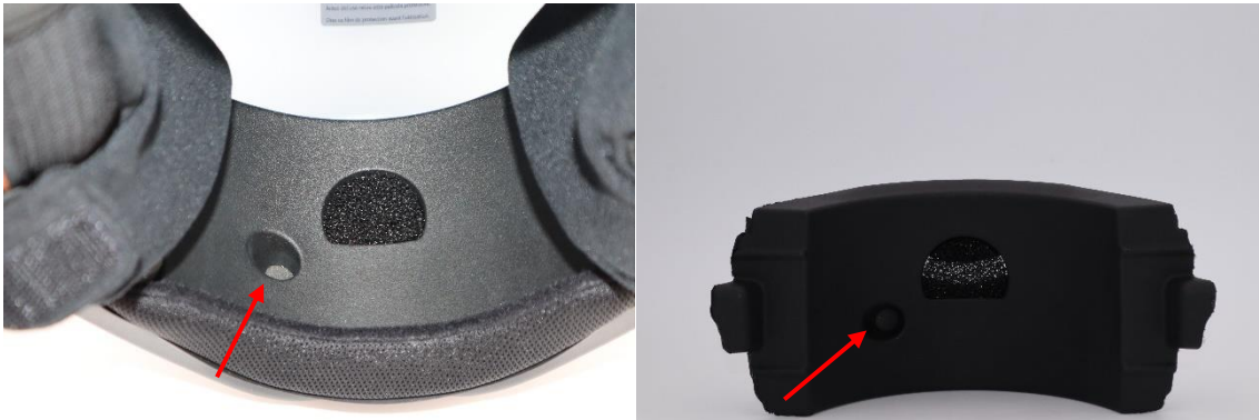
Fig. 4 Mounting Position of SC2 microphone behind chin protective padding (pos. 6) Abb.4 Einbauposition des SC2 Mikrofon hinter dem Kinnschutz (Pos. 6)
